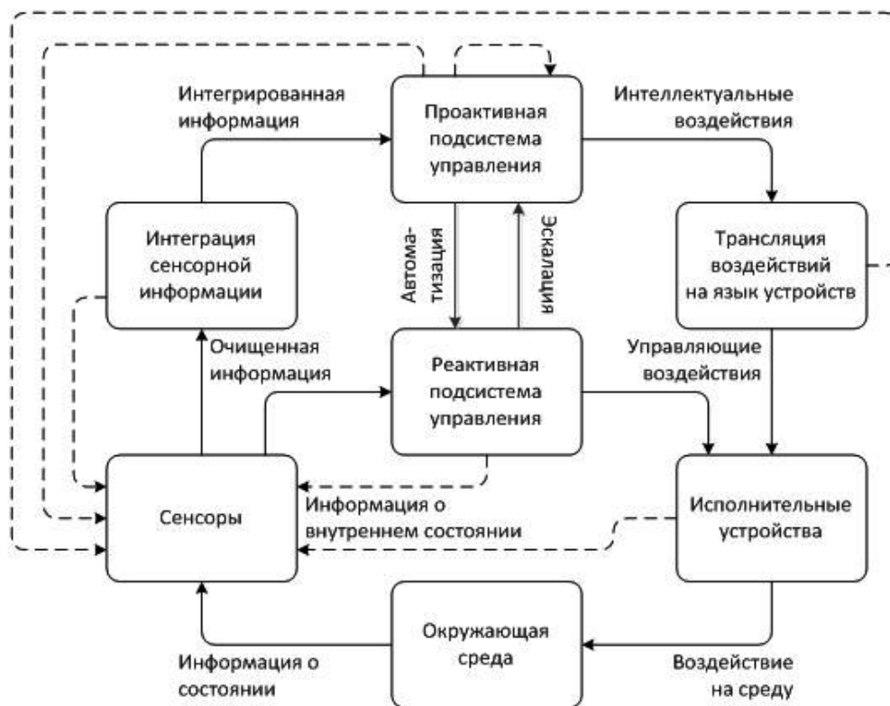
Рис. 2. Усовершенствованная архитектура гибридной виртуальной модели цифрового двойника промышленного предприятия
