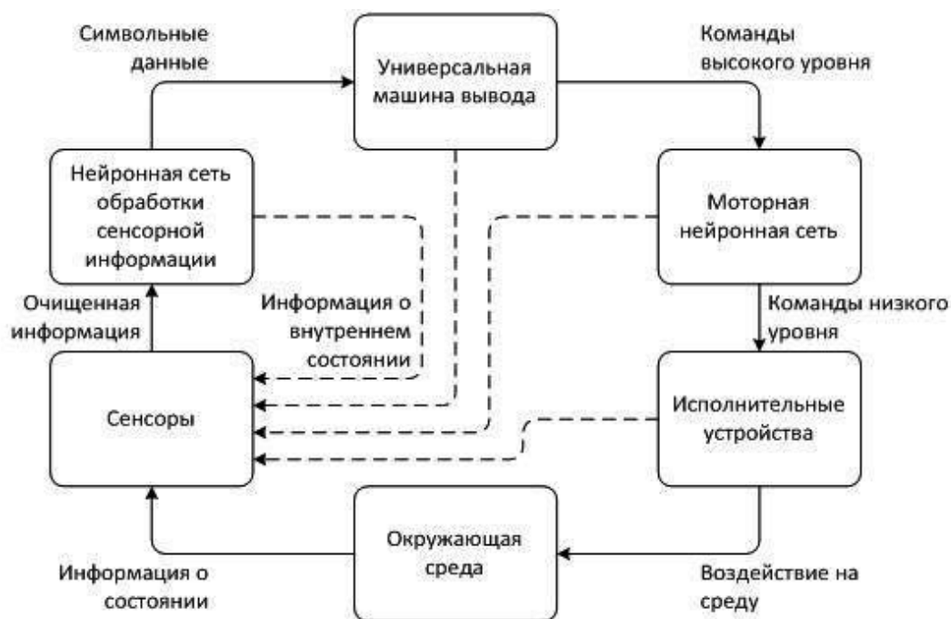
Рис. 1. Общая схема архитектуры гибридной виртуальной модели цифрового двойника промышленного предприятия
